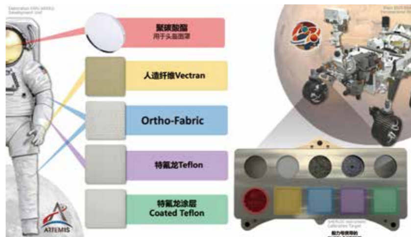
图4 跟随毅力号抵达火星的宇航服测试材料。左图标注了各种材料在宇航服上的用途,色标对应着右图中SHERLOC定标版上的材料位置(NASA/JPL)
